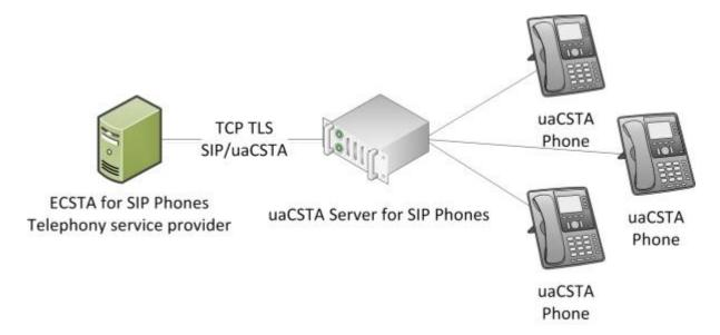
Der ECSTA for SIP Phones stellt als Telephony Service Provider (TSP) eine standardkonforme TAPI Schnittstelle zur Steuerung der Endgeräte bereit. Der Treiber wird in Verbindung mit TAPI nutzenden Applikationen eingesetzt (UCServer, ProCall, andere TAPI Applikationen)
